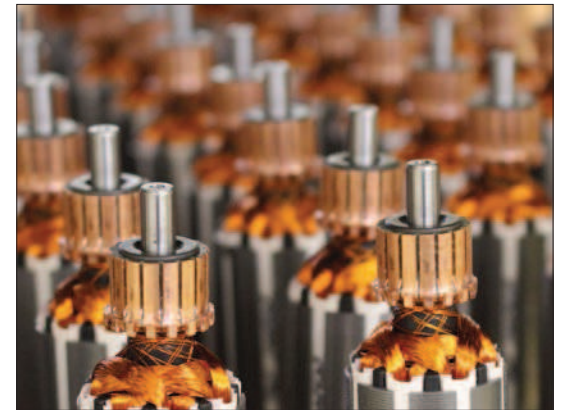
Bürstenbehaltete Motoren mit gewickeltem Läufer und Ständer erreichen hohe Drehzahlen und lassen sich einfach über die Spannung regeln.
